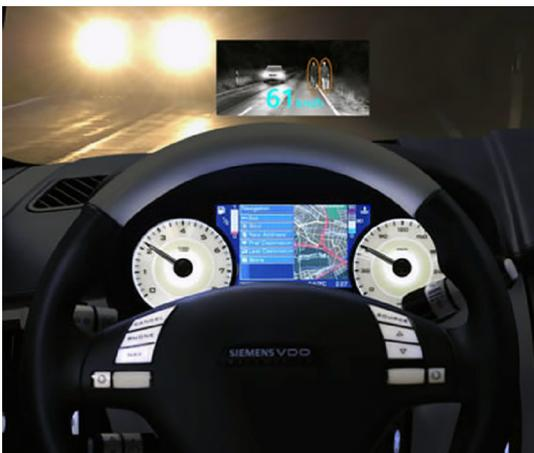
Figura 7. Sistema de "night vision" incorporado no para-brisas. © Siemens.
