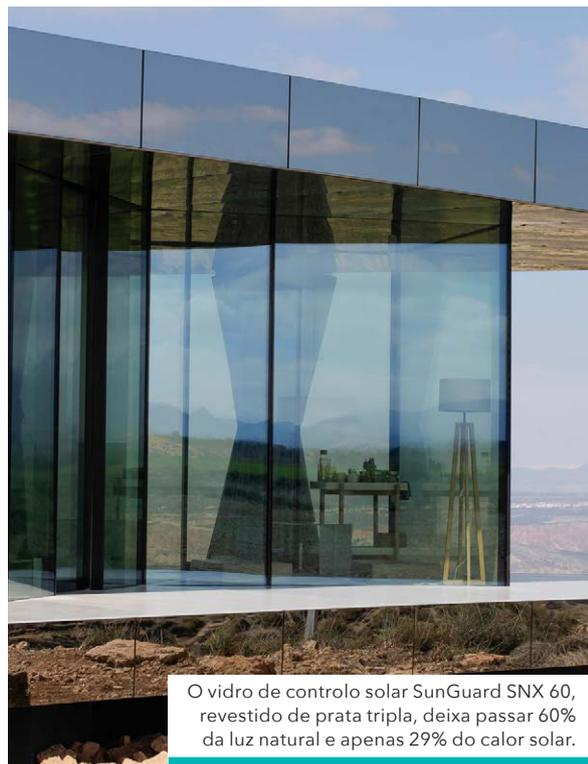
O vidro de controlo solar SunGuard SNX 60, revestido de prata tripla, deixa passar 60% da luz natural e apenas 29% do calor solar.
